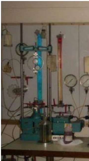
Gambar 3. 1 Alat uji triaksial dan kelengkapannya
