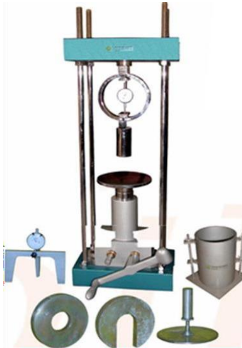
Gambar 1.1 Peralatan utama untuk uji CBR laboratorium. Silinder pemadatan CBR dengan diameter 6 in. dan tinggi 7 in., dilengkapi dengan silinder sambungan tinggi 2 in., dan pelat alas tebal 3/8 in. yang berlubang-lubang (lihat Gambar 1.2)
