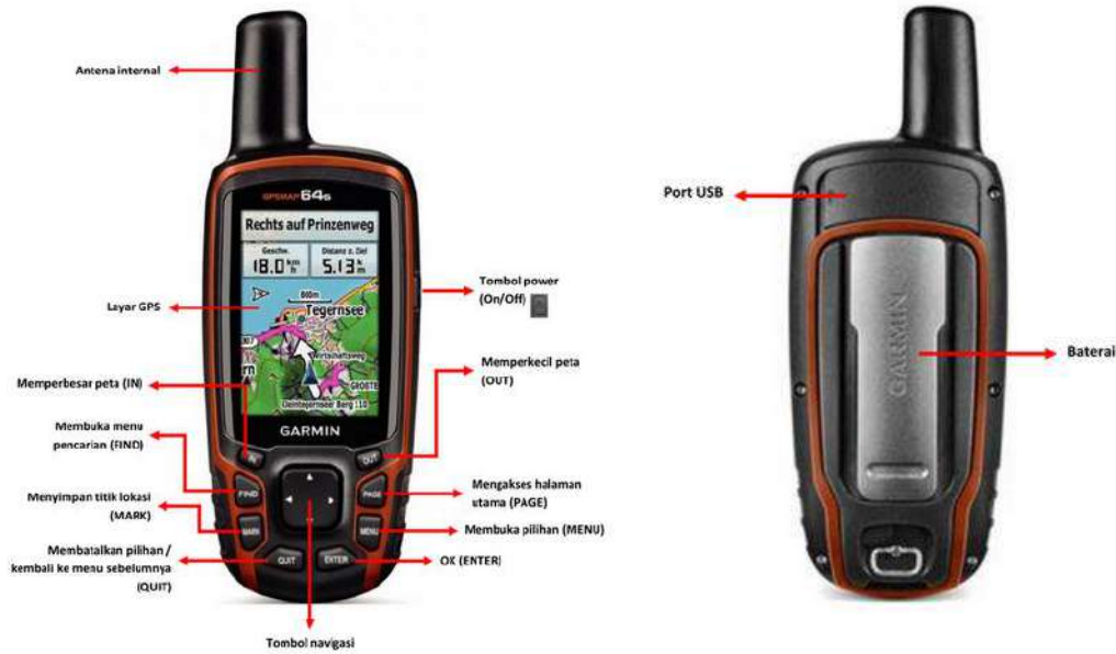
Gambar 5. 1 Tampilan dan bagian-bagian dari GPS Garmin
