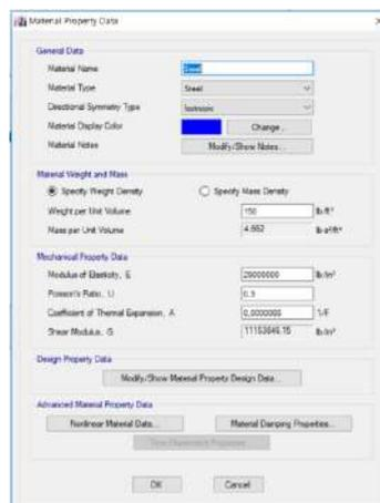
Gambar 3.11 Kotak dialog *Material Property Data* untuk baja
